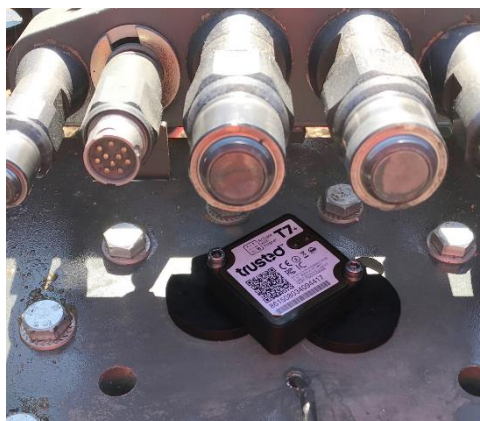
Abb. 3: Befestigung eines Trackers mit Magnethalterung
